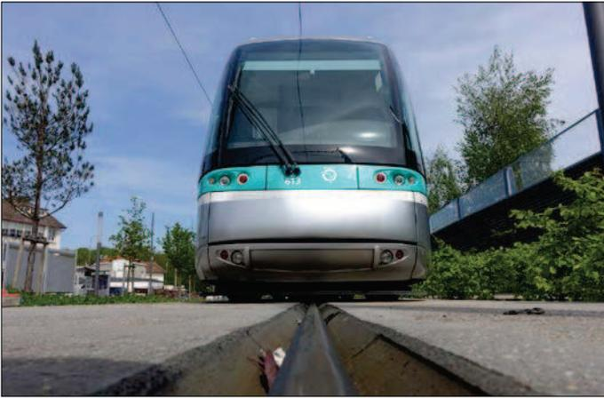
In die Führungsschiene greifen zwei Räder mit Spurkranz im 45-Grad-Winkel ein. Für einspurige Fahrzeuge ist die Rille eine gefährliche Falle.
