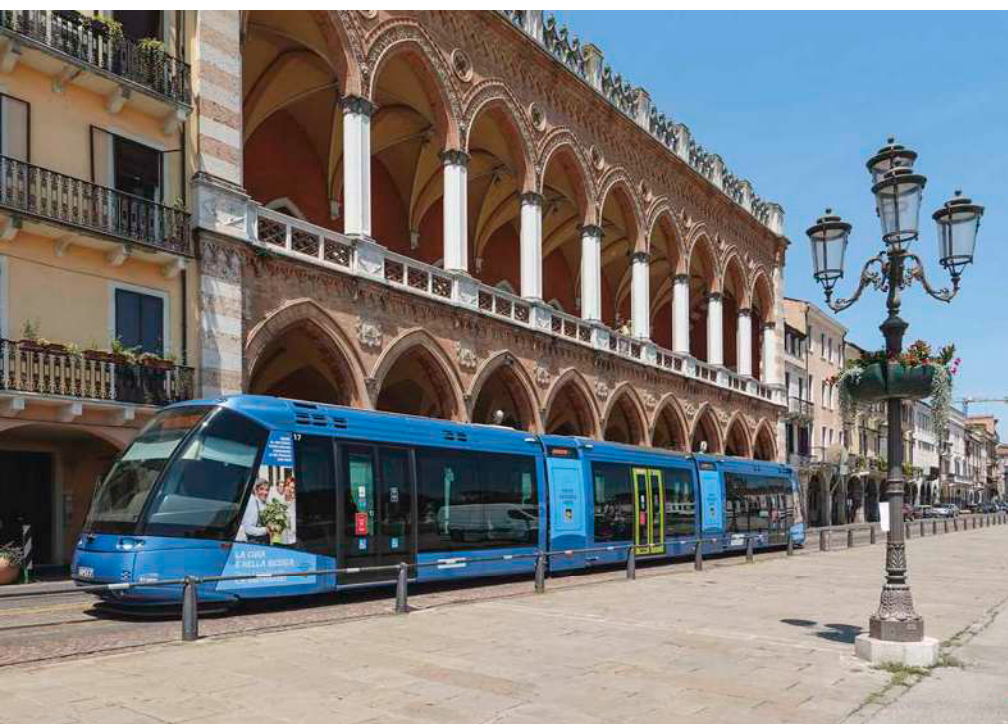
Padua ist die einzige Stadt, die den Translohr weiter ausbauen möchte. Auf dem grandiosen Prato della Valle ist die Bahn, um das historische Bild zu schonen, ohne Fahrdrat unterwegs
