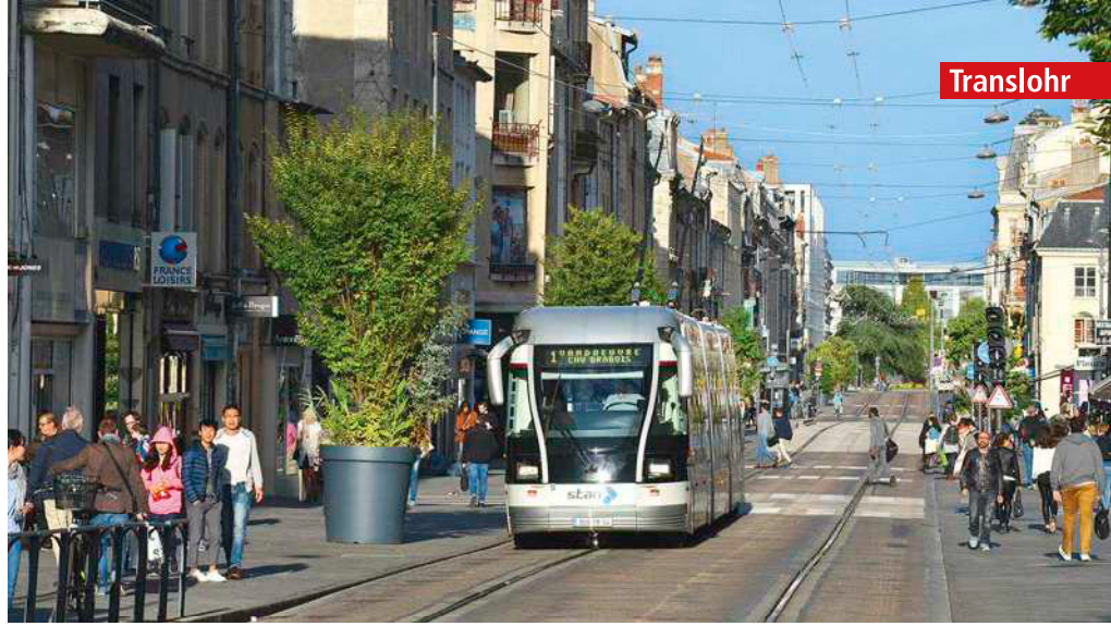
In Nancy wollte man zu viel: So kann der Spurbus sein Gleis verlassen, weshalb eine zweipolige O-Bus-Fahrleitung nötig war
