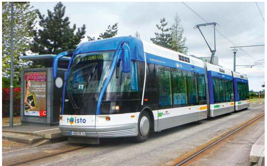
Zuvor fuhr der Spurbus in Caen mit klassischer, einpoliger Oberleitung. Unterwerke und Teile der TVR-Infrastruktur konnten für die Tram weiterverwendet werden
