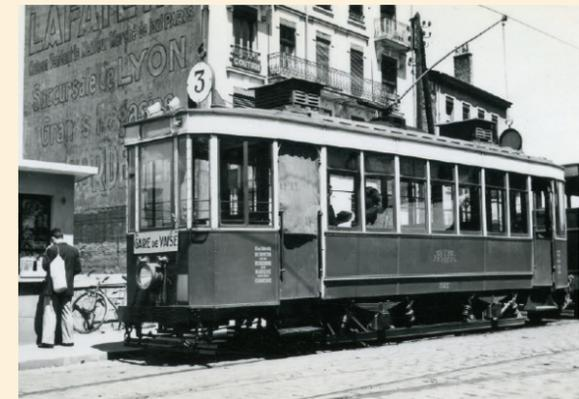
Die Serie 301 bis 370, hier ein Wagen im Jahr 1949, waren knapp zehn Meter lange Zweiachser mit Sieben-Fenster-Wagenkasten. Die Serie wurde in den Jahren 1909 bis 1913 bei La Buire in Lyon gebaut. Sie bedienten nach 1945 die Linien 3, 7 und 10 und standen bis 1954/1955 im Einsatz
