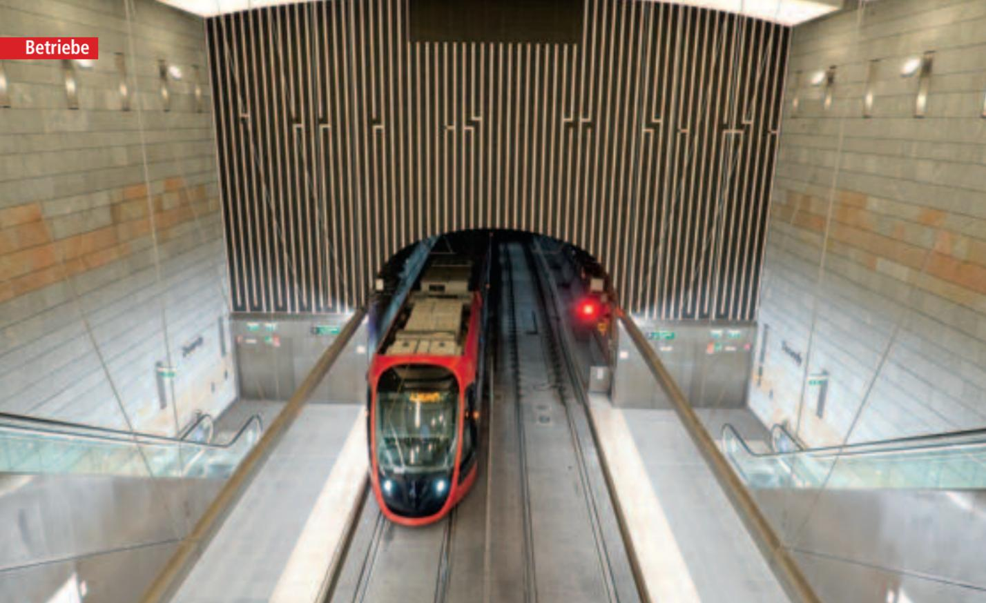
In den Tiefstationen sorgt eine Oberleitung für ausreichend „Saft“ – sie spiegelt sich im Bild in der Frontscheibe und ist sehr schlank gebaut
