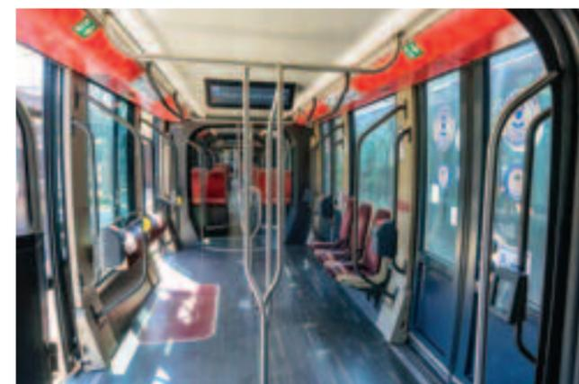
Die Zwischenmodule der neuen Citadis 405 sind unterschiedlich: Die beiden äußeren Sänften haben zwei Doppeltüren und Rollstuhl/Kinderwagenplätze; die mittlere dagegen nur eine Türe und Längssitze
