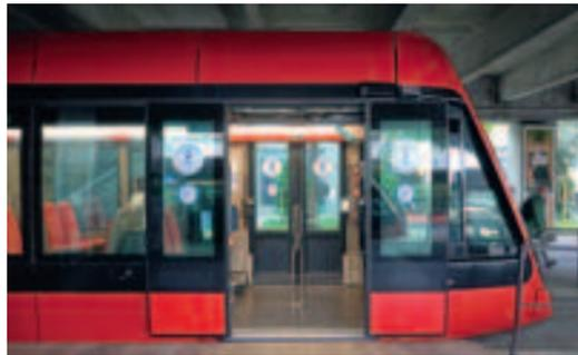
Ein Zug der T3 an der Flughafenstation: Die breite Doppeltüre am Wagenende beschleunigt den Fahrgastwechsel im Vergleich zur ersten Fahrzeuggeneration mit Einzeltüre
