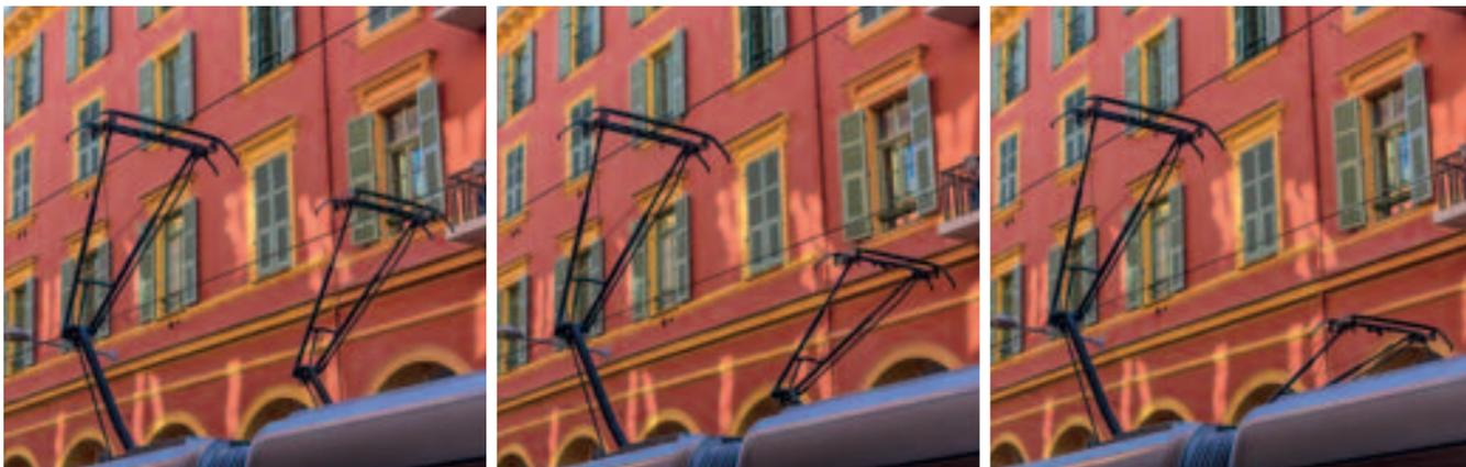
Vom Fahrgast der Linie T1 unbemerkt wird an zwei oberleitungslosen Streckenteilen in Nizza der Bügel abgezogen; dann geht die Fahrt per Batterie weiter. Selten, aber doch gelegentlich, kommt es beim Umschalten zu Verzögerungen
