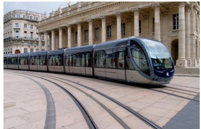
Abb. 3: Fußgängerzone in Bordeaux: Um das historische Stadtbild zu schonen, führt man den Strom unterirdisch zu.
